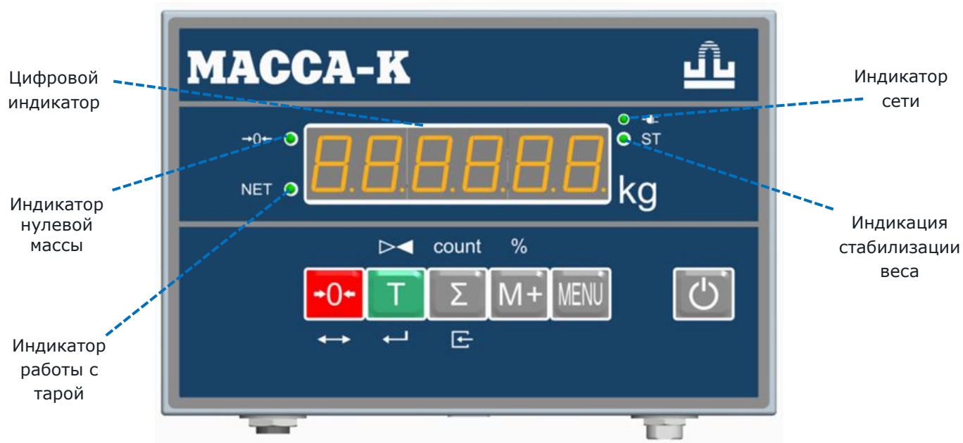
Передняя панель терминалов АВ и АВ(RUEW)
