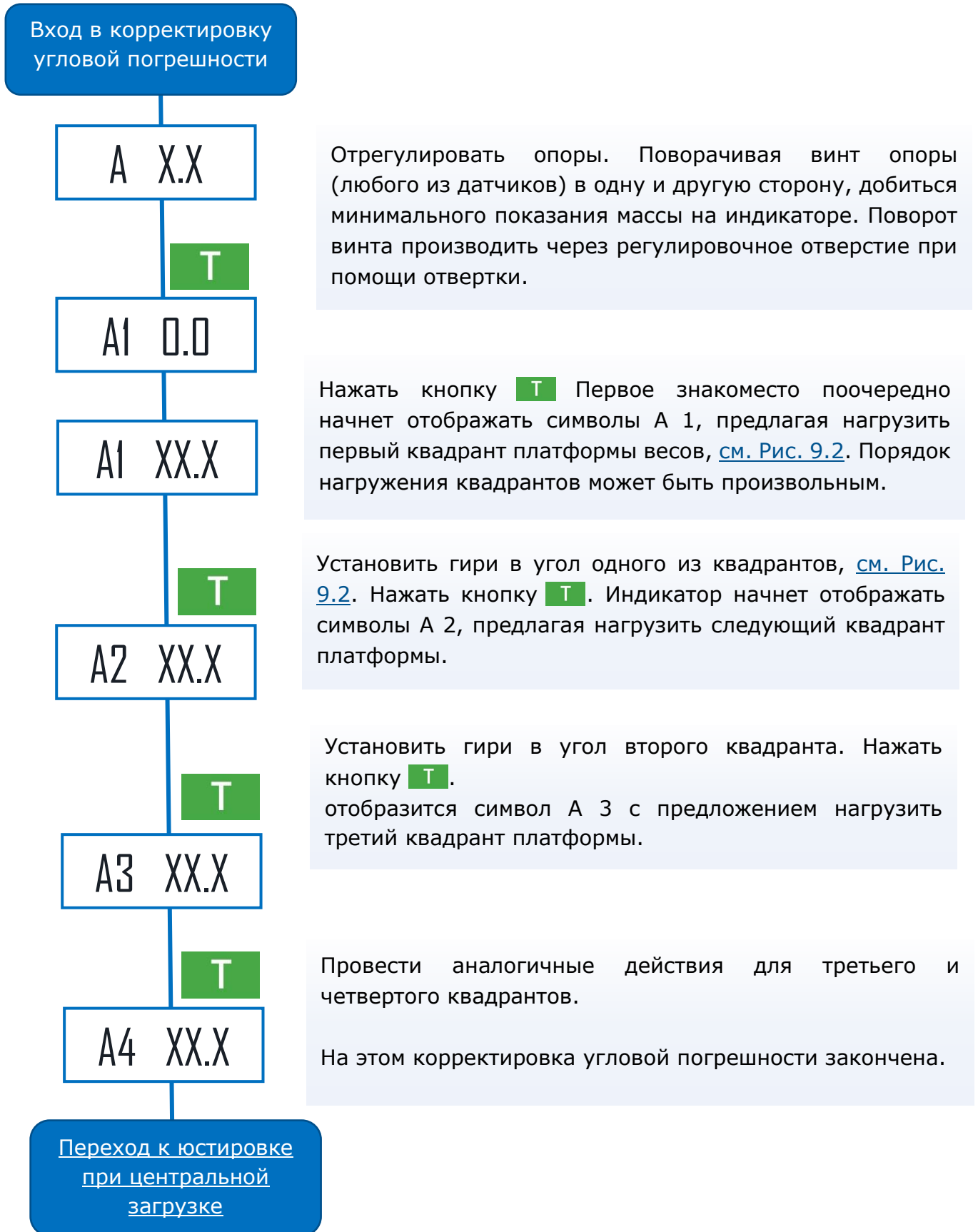
Рис. 9.3. Последовательность корректировки угловых погрешностей модулей 4D.
